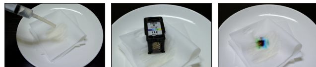
キヤノン、HP、Lexmarkなどの、一体型カートリッジのクリーニング
