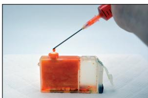
写真1 - 穴を使わない「高速」詰め替え
